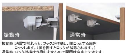
振動時 地震で揺れると、フックが作動し、開こうとする扉をロックします。(扉を押すとロックが解除されます。)
